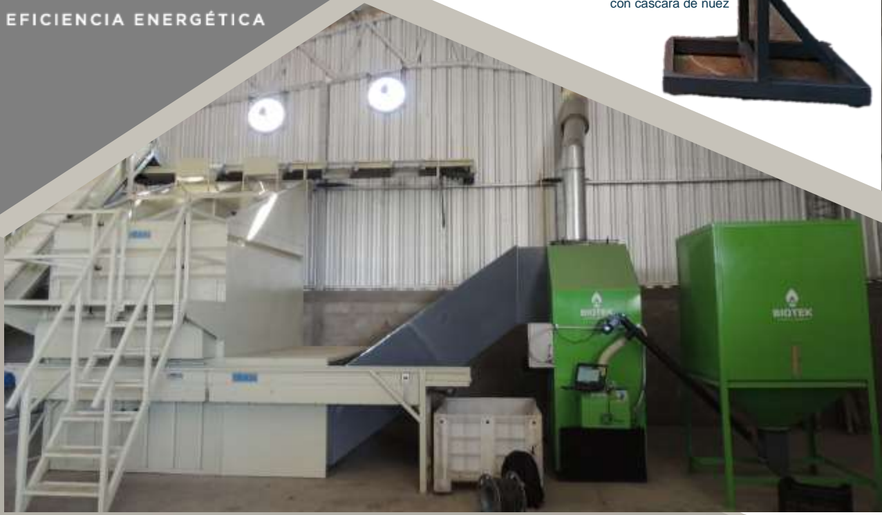
Quemador de biomasa QBT500 Pruebas de combustión con cascara de nuez
